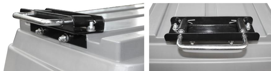
4. Fixer le cadre avant sur le couplage à l'aide de 2 vis tête H M8 x 20, 2 vis M8 x 20, rondelles plates, rondelles grower et écrous freins (D et C).
