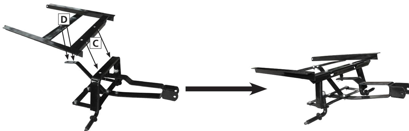
5. Poser le cadre avant avec couplage sur la caisse retournée et le fixer à l'aide de 2 vis M8 x 20, rondelles plates, rondelles grower et écrous freins (C).
